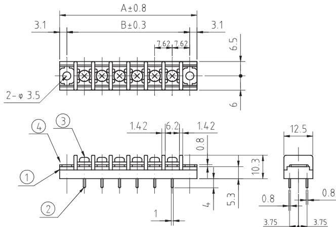
2本足タイプは、電流容量が大きいだけでなく、プリント基板のパターンへの半田付け強度を増します。
