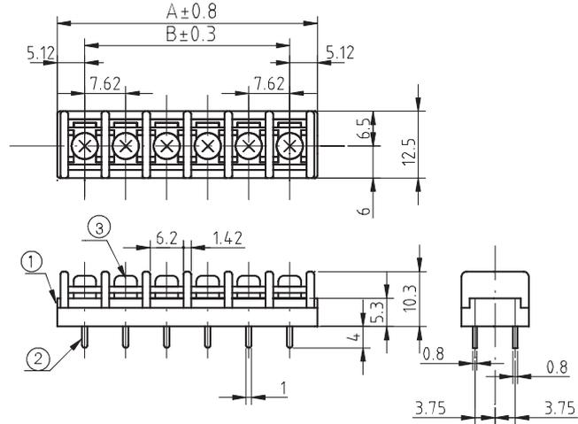
2本足タイプは、電流容量が大きいだけでなく、プリント基板のパターンへの半田付け強度を増します。
